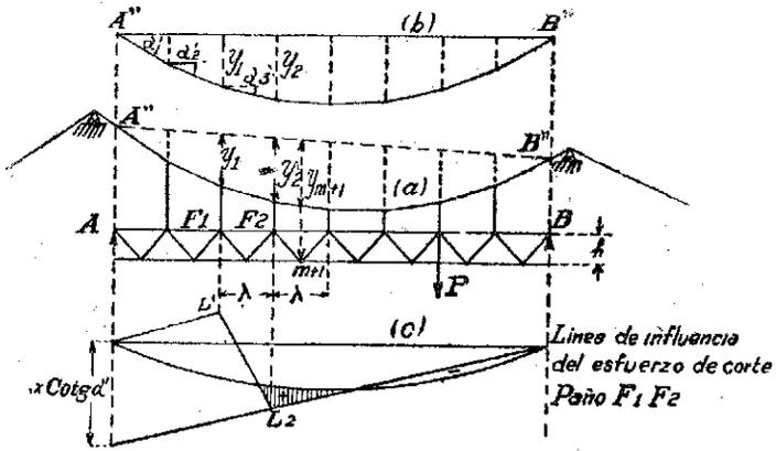
Llevando las ordenadas  $y_1, y_2$  a partir de una línea de cierre horizontal (fig. b) y designando por  $\alpha'$  el ángulo de inclinación de la nueva catenaria así obtenida, podemos establecer la siguiente ecuación:
